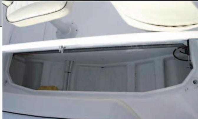
▲ El cofre de la bañera es de grandes dimensiones y su tapa se sostiene por un pistón hidráulico. Es el alojamiento de las baterías.
