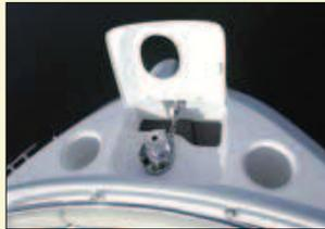
El pozo de anclas queda completamente cubierto gracias a su tapa, que no es necesario abrir para el fondeo. En sus laterales tenemos dos portadefensas.
